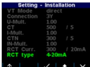
Wenn ein RCT mit DC-Ausgangsstromschleife 4/20 mA oder 0/20 mA verwendet wird, schalten Sie zuerst den **RCT-Typ** entsprechend um, indem Sie den  $I_{RCM}$ -Multiplikator bearbeiten. Geben Sie anschließend den RCT-Primärstrom entsprechend dem 20-mA-DC-Ausgang ein (in Milliampere – im obigen Beispiel wird ein Wandlerverhältnis von 300 mA/20 mA eingestellt). Der dem Strom 0 oder 4 mA entsprechende Wert kann nicht eingestellt werden – er wird automatisch zu Null angenommen.
