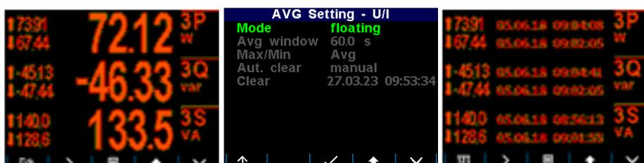
Die registrierten Maximal- und Minimalwerte können manuell gelöscht werden, oder es kann das automatische Löschen eingestellt werden.
