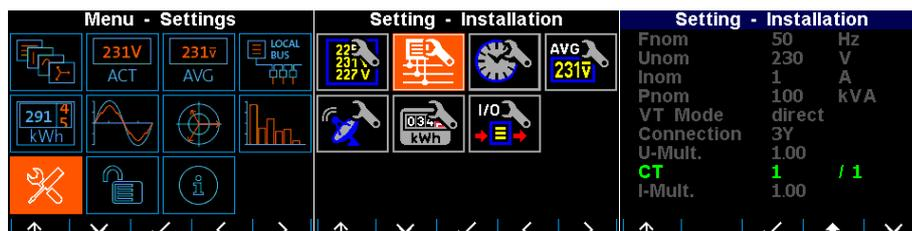
Nun können Sie den neuen Parameterwert eingeben: Mit der Schaltfläche **>** können Sie von einer Ziffer zu einer anderen wechseln und jede Ziffer mit den Schaltflächen **↑** und **↓** auf ihren Zielwert einstellen. Drücken Sie zum Abschluss die Schaltfläche **✓**. Damit ist der Parameter eingestellt.
