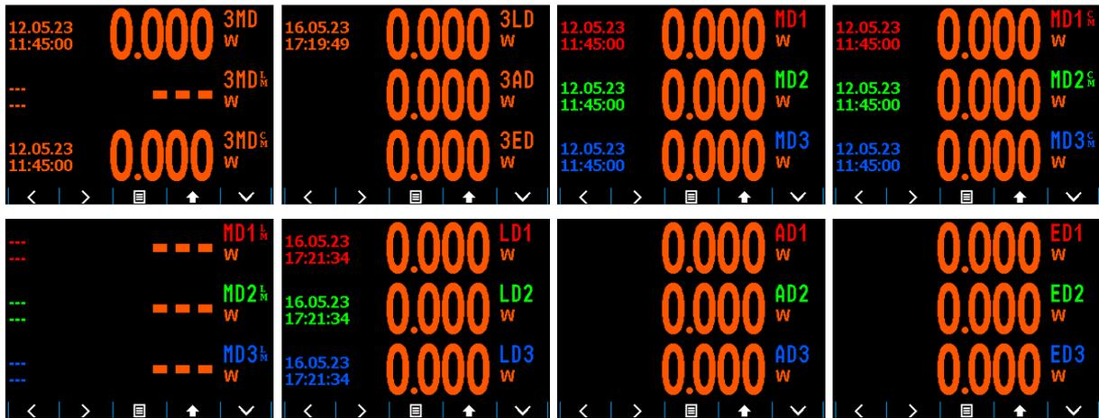
Durch Herunterscrollen gelangen Sie in den einphasigen Zweig der maximalen Bedarfswerte. Hier können Sie die Bedarfswerte für einzelne Phasen abfragen.
