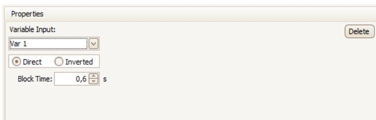
Abbildung 27: I/O-Einrichtung – Eigenschaften der Variablen-Bedingung
