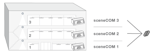
Bild 41: Konfiguration der Vernetzung in einem Treppenhaus
